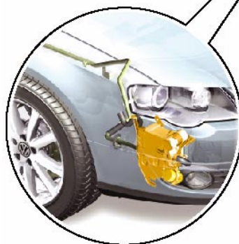
Блок управления автономным отопителем J364, в нише правого колеса
