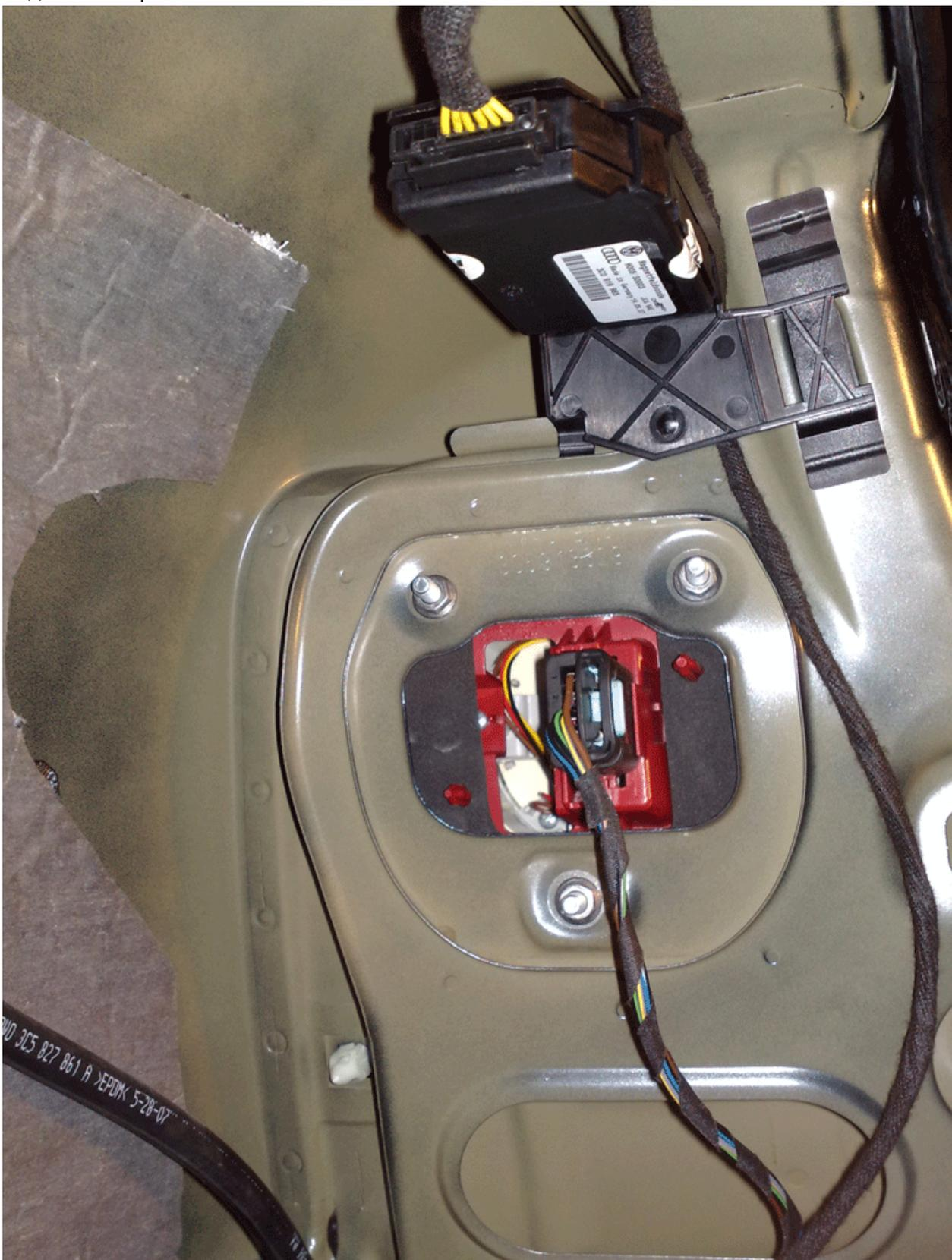
Теперь в разъем №1 щитка предохранителей устанавливаем предохранитель на 5 ампер.
