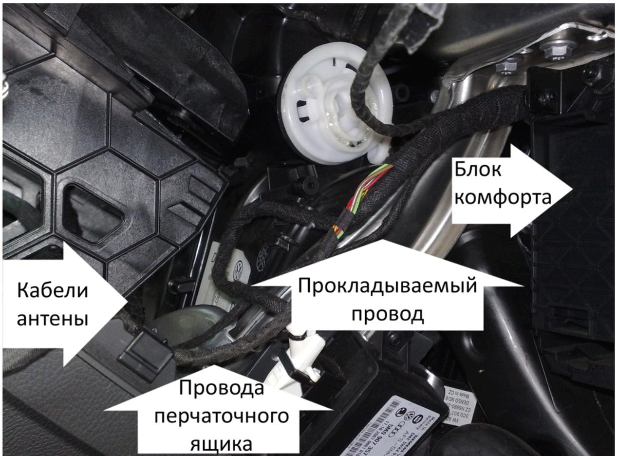
В контактном разъеме магнитофона, в пинах 9 и 10 находим два провода: оранжевый-фиолетовый и оранжевый-коричневый, это CAN-Infotainment. Оранжевый-фиолетовый соответствует проводу High, оранжевый-коричневый – Low. Я извлекал контакты из разъема, чтобы изолировать термоусадочной трубкой и не пересекать провод. А так достаточно просто надсечь изоляцию данных проводов, примотать к ним наши провода, желательно пропаять и хорошо изолировать.
