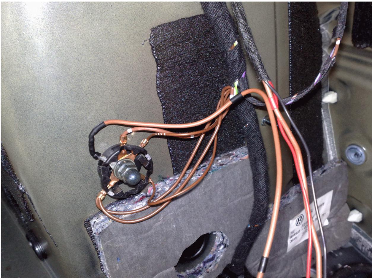
Провод массы объединяем с остальными проводами и прокладываем вдоль кабеля идущего к заднему фонарю.
